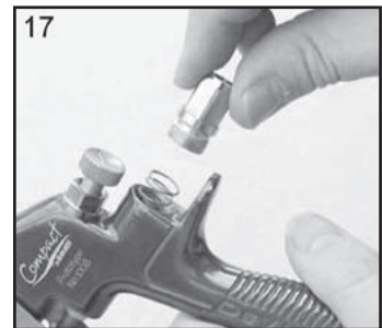
17. Vuelva a colocar el muelle de la válvula y vuelva a colocar en el alojamiento (10).
