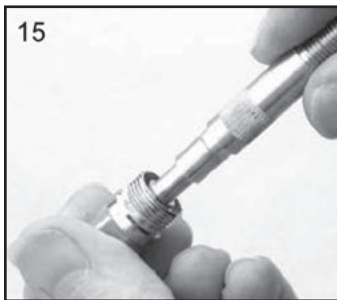
15. Coloque la junta en el alojamiento (10).
